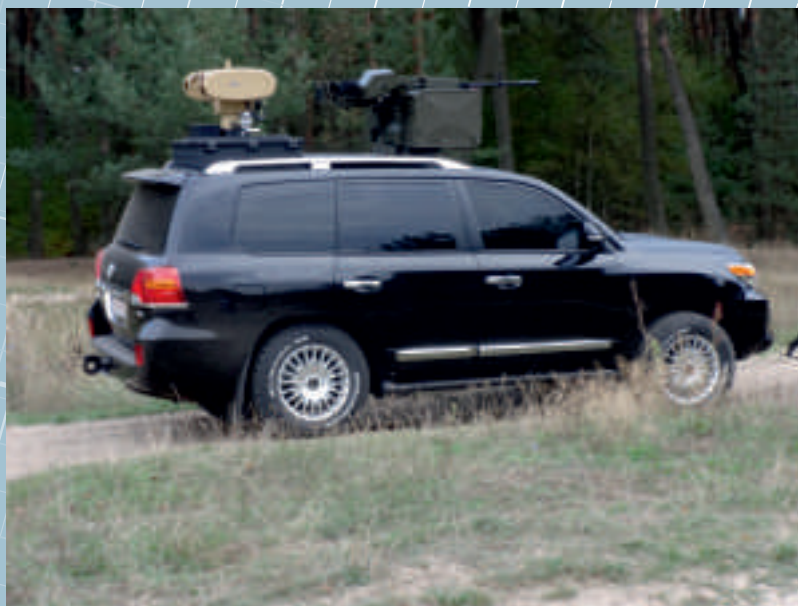
Rys. 1. Pojazd w konfiguracji z radarem i złożonym masztem
