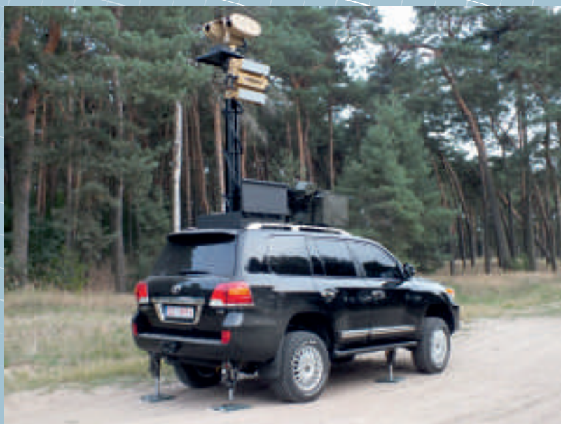
Rys. 2. Pojazd w konfiguracji z radarem i rozłożonym masztem
